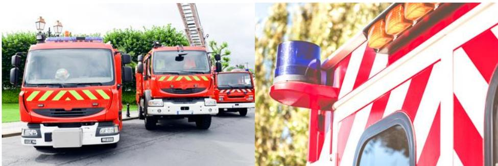
ソフト・ハイ・インテンシティ・グレード #62000シリーズは優れた柔軟性を持った高輝度反射シートで平面だけでなく三次曲面や細い支柱などにも貼り付けられます。
